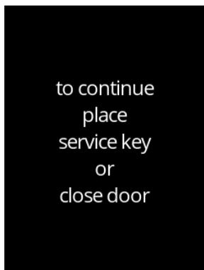
Wenn die Tür geöffnet wird, wird der Sicherheitsschalter aktiviert und eine Meldung angezeigt. Die folgende Hardware wird deaktiviert:
